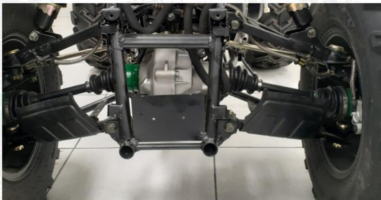
A suspensão dianteira é em forma de A, sendo eficiente em ambas as direções atendendo todas as necessidades do piloto.
