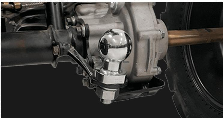
Todas as versões contam com um engate esférico como item de série, com capacidade de reboque de até 544 kg.
